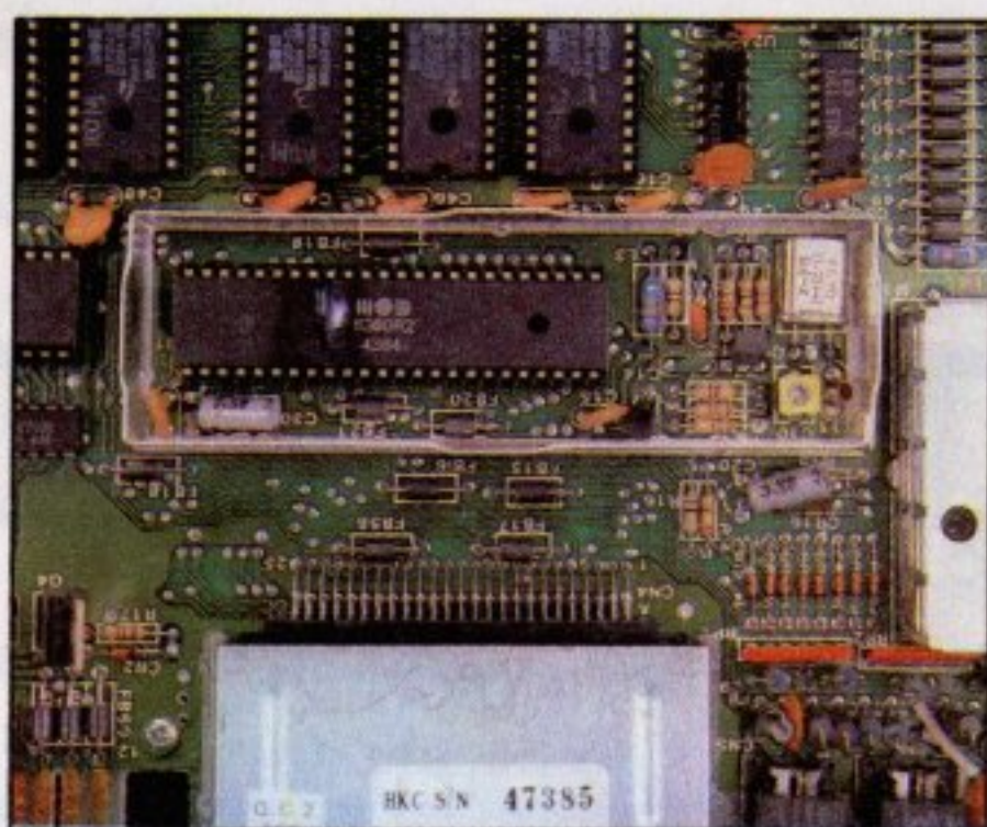
L'8360, quasi un'ULA visto che gestisce al contempo il video e il sonoro. Per evitare interferenze in alta frequenza è usualmente protetto da una gabbia metallica, cui è anche accoppiato termicamente per migliorare la dissipazione: si noti infatti il residuo di silicone (la macchia bianca), che tiene l'aletta fissata al chip.
