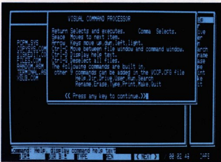
Videata del VCCP in ambiente CP/M. Si nota la finestra di help sovrapposta alla pagina in uso.
