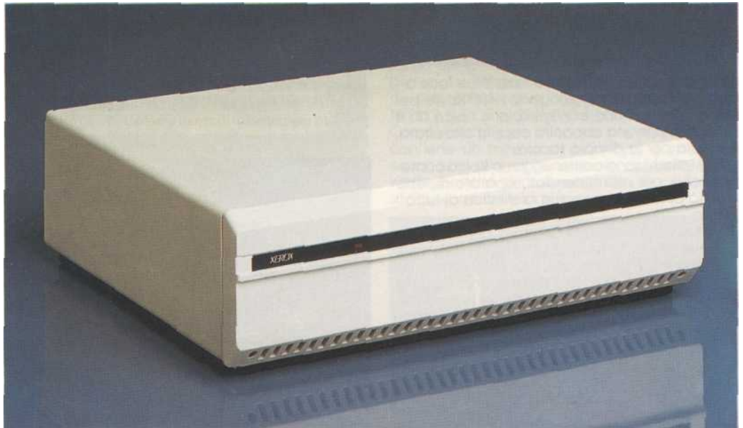
Il box di espansione che racchiude diverse schede, tra le quali quella del processore 8086 a 16 bit, scelto dalla Xerox (la abbinare allo Z80 già presente nel monitor).
