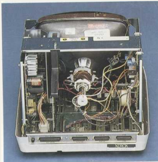
Una vista interna del monitor rende evidenti la scheda dell'alimentatore, quella di controllo del tubo CRT e, in basso, la mother-board del processore a 8 bit.
